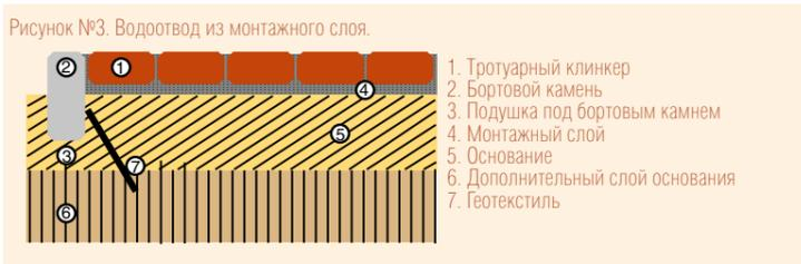
ния от фундамента до обычной линии каплепадения с козырька крыши, но не менее 50 см. При этом конструкция дорожной одежды должна включать дренажную или водоотводящую прослойку под монтажным слоем. Для одинакового зрительного восприятия всего тротуара, верхняя часть швов, в указанной полосе, должна быть заполнена тем же материалом, что и в швы на оставшейся части покрытия.
