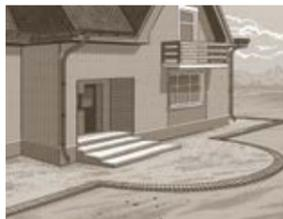
Вид бордюра с уплотненным несущим слоем. Поверхность подготовлена к устройству монтажного слоя и мощению.
